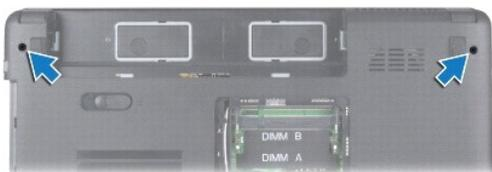
8. Снимите крышку центральной панели (см. раздел [Снятие крышки центральной панели](#)).
